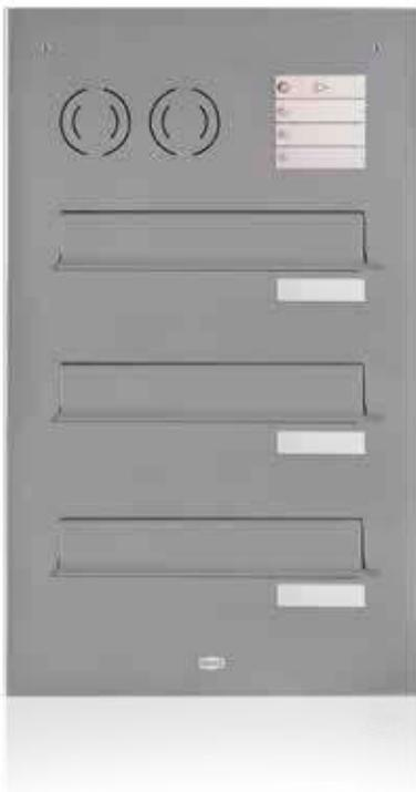
Elegante flache Frontplatte mit nur 2 bzw. 2,5 mm Dicke. Verschraubung der Front mit den Kästen mittels Kunststoffecken, auch ohne Frontüberstand verbaubar. Auf Wunsch mit RS1000-Abschlussrahmen und integriertem Regenabweiser lieferbar. Erhältlich aus Galfan-Stahl, Aluminium oder Edelstahl V4A.
